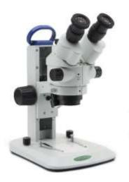
Stereomicroscopio trinoculare, 7x...45x
